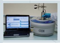
Avec une température pouvant aller de 20°C à 300°C, à pression atmosphérique ou jusqu'à 21 bar, l'appareil microonde de CEM, Discover LabMate, permet d'accroître le potentiel de notre laboratoire et la vitesse de nos synthèses. With a temperature evolving from 20°C to 300°C, with atmospheric pressure or pressure up to 21 bar, the CEM Discover LabMate-Research Scale Synthesizers Microwave allows our laboratory potential and synthesis speed increasing.
