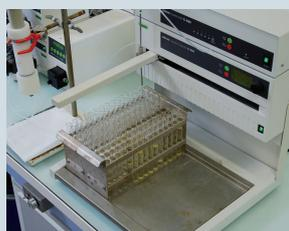
L'acquisition d'un détecteur UV (200, 220, 254, 280 nm) et du logiciel de pilotage complète notre système de chromatographie préparative BUCHI (Sepacore) et permet ainsi d'optimiser les étapes de purification en utilisant des cartouches de tout type (SiO<sub>2</sub>, C18, ...).
