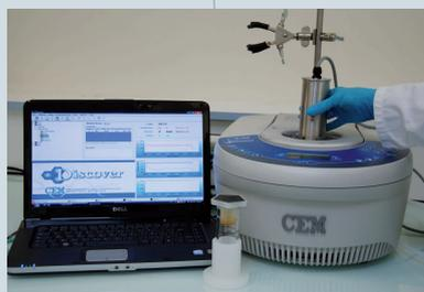
Avec une température pouvant aller de 20°C à 300°C, à pression atmosphérique ou jusqu'à 21 bar, l'appareil micro-onde de CEM, Discover LabMate, permet d'accroître le potentiel de notre laboratoire et la vitesse de nos synthèses.
